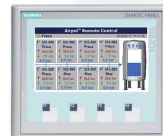
Применение системы управления группой компрессоров исключает необходимость вмешательства обслуживающего персонала в настройку и позволяет равномерно распределять нагрузку.
