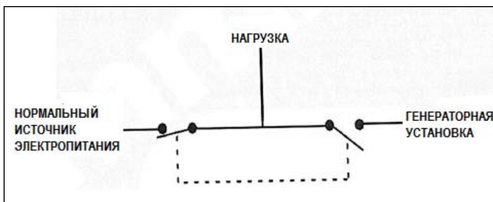
Рис. 15 Функция типового устройства переключения нагрузки
