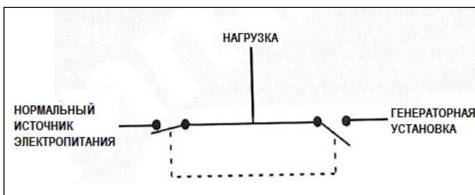
Рис. 12 Функция типового устройства переключения нагрузки
